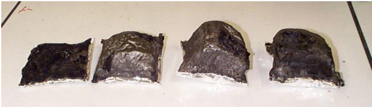
Figure 4: optimisation de l'intumescence dans le PA6 en équilibrant les ratios de réactifs
